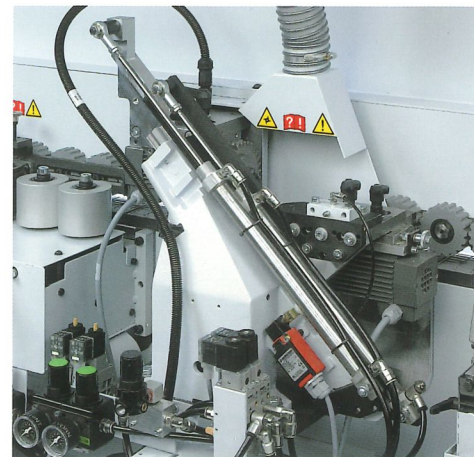
Kappaggregat Fase-/Gerade Einstellung durch einfaches Schwenken.
