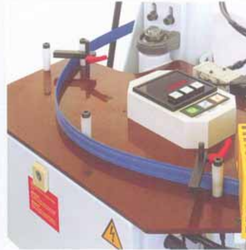
Die Kanten werden automatisch auf das eingetragene Maß abgelängt
