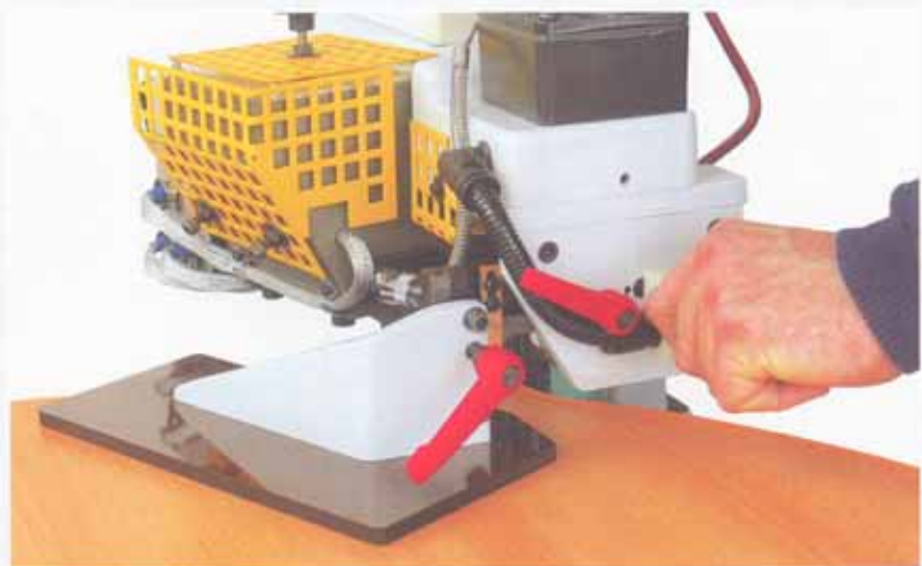
Führung des Verleimteils durch die höhenverstellbare Führungsplatte
