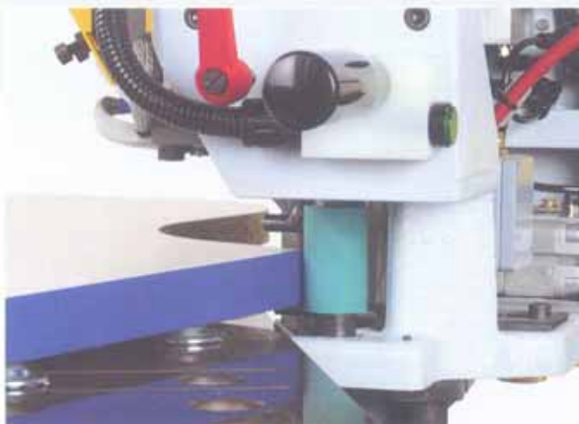
Schnelle Umrüstung zur stationären Kantenanleimmaschine
