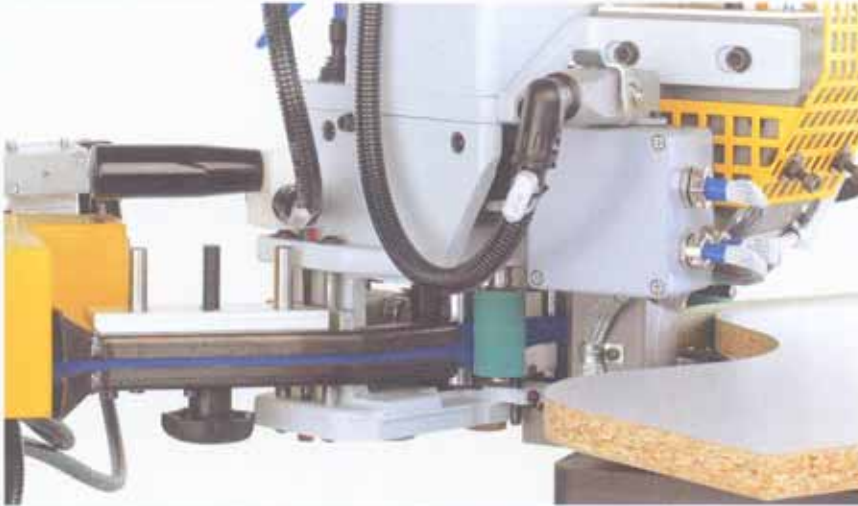
Sichere Kantenzuführung bei Stationär- oder Handbetrieb
