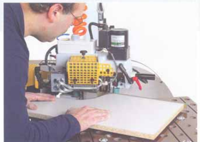
Kleine Werkstücke werden im Stationärbetrieb bearbeitet
