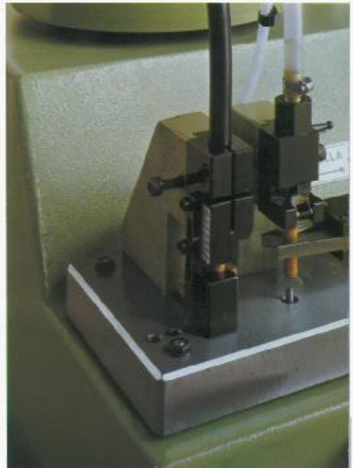
Gruppo meccanico-pneumatico della macchina Mod. GLN/520 che alimenta la pistola.
