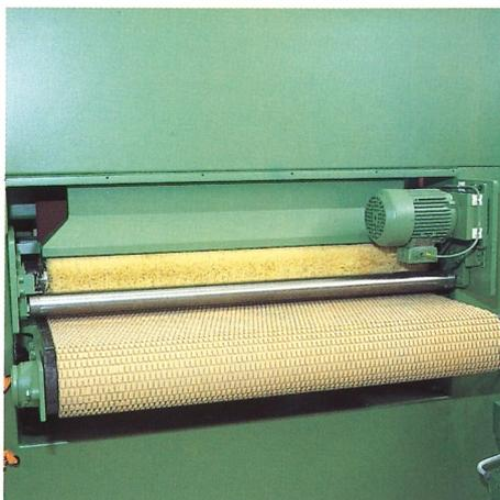
Maschinenauslauf mit Antriebsmotor für die Werkstückreinigungsbürste
