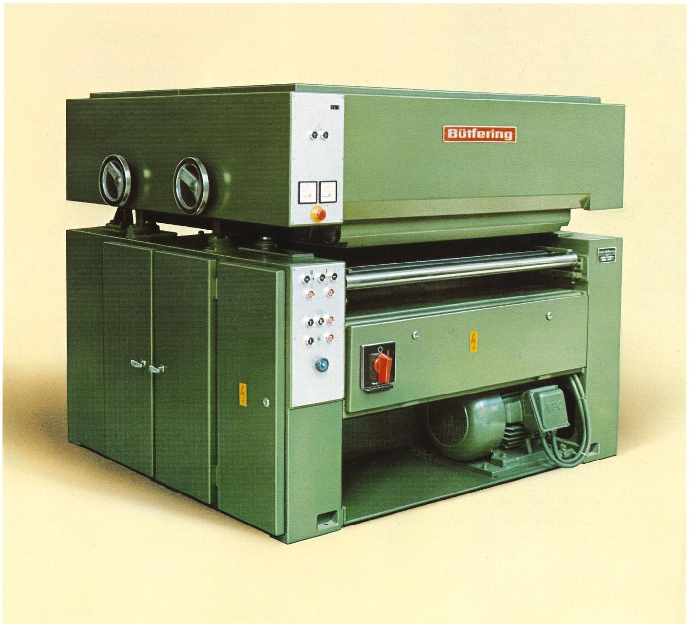
Alle holzverarbeitenden Betriebe, selbst kleinste Werkstätten, sind den heutigen Marktanforderungen entsprechend, auf den Einsatz moderner und damit rationaler Bearbeitungsmethoden angewiesen. Der mit 2 Bändern von unten schleifende Büttering-Feinschliffautomat FBS 2 – mit Digitalanzeige der Werkstückstärke und elektromotorischer Einstellung – ist speziell für größere Innenausbaubetriebe und Möbelfabriken
