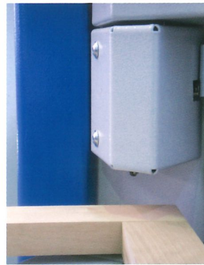
automatische Werkstück- dickenerkennung
