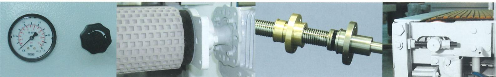
Einfache Regulierung des Schleifdrucks im Luftkissen-Schleifschuh
