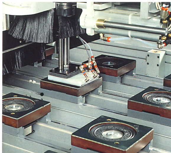
UNITÀ SPECIALE PER POSIZIONAMENTO PIANI E VENTOSE GESTITO DA CN.
