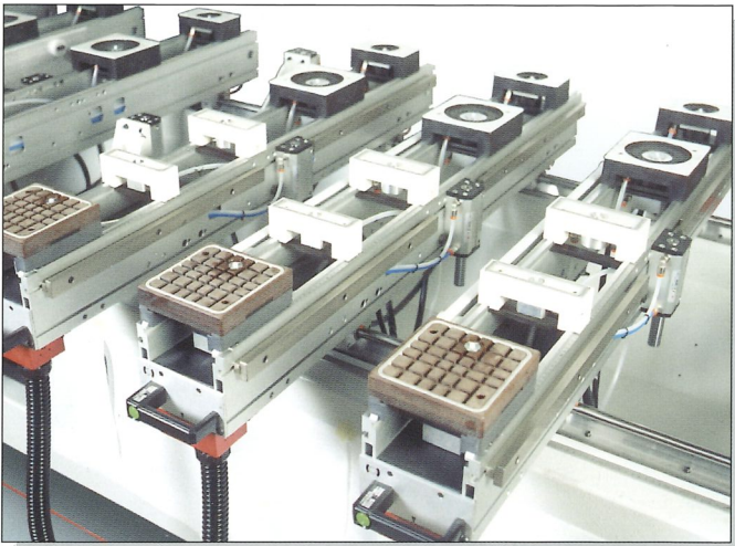
Système de blocage à ventouses, diversifiées selon la dimension des pièces.
