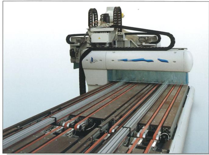
Arbeits-tisch mit doppelter Bearbeitungslänge bestehend aus 4 unabhängigen Arbeitszonen.
