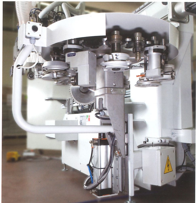
18-position rear rotary tool changer hinteres Werkzeugmagazin mit 18 Positionen magasin rotatif arrière à 18 positions
