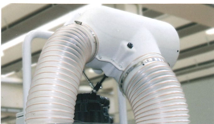
convogliatore di aspirazione parzializzato partialized dust extraction collector conductor de aspiración parcializado
