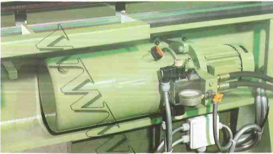
Centralina oleodinamica delle taglierine Mod. CIM Hydraulic unit on CIM Guillotines Unité hydraulique des Massicots Mod. CIM Hydraulikaggregat bei Furnierscheren Mod. CIM
