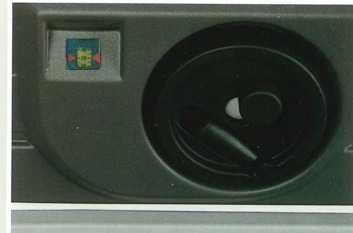
▲ Volantino inclinazione lama con visualizzatore, situato sulla parte frontale della macchina. Movimenti montati su cuscinetti a sfera per facilitare la manovra.
