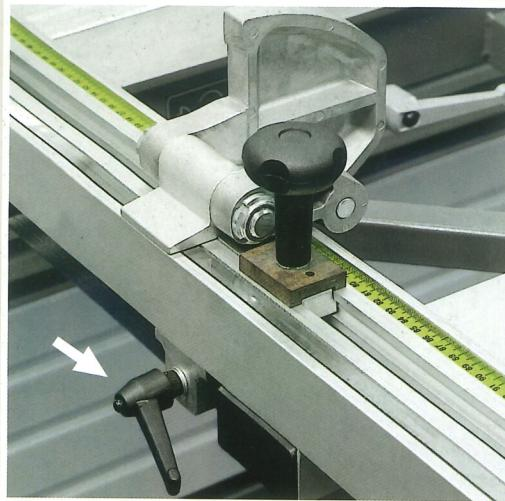
▲ Il nuovo registro telescopico, con fissaggio a mezzo leva, consente di velocizzare notevolmente le operazioni di montaggio e smontaggio dello stesso sulla slitta trasversale.
