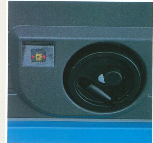
▲ Volantino inclinazione lama con visualizzatore, situato sulla parte frontale della macchina. Movimenti montati su cuscinetti a sfera per facilitare la manovra.
