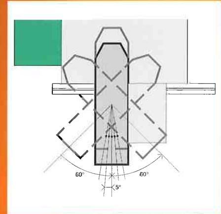
**Carro per tenonare completo di piano centrale prolungato per profilatura e piano superiore inclinabile -60° +60° per tenonatura. Inclinazione del piano superiore su tavola indexata con fissaggio attraverso spina inserita in fori di riferimento ogni 5° che garantiscono una elevata precisione. Possibilità di usare il carro per tenonare come prolunga piano nelle operazioni di profilatura.**
