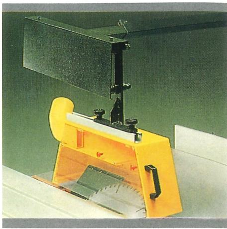
● **Protezione lama** a parallelogramma
