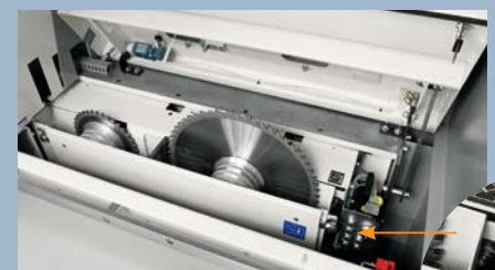
Freigabe der pneumatischen Flansche mittels Wahlschalter
