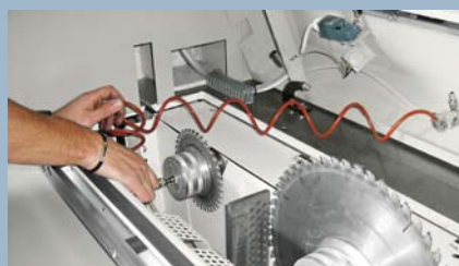
Pneumatische Verriegelung der Haupt- und Vorritzsägeblattflansche
