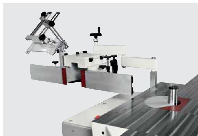
Braccio di esclusione rapida (di serie sulle versioni A) Dispositivo para exclusión de la guía tupis (de serie para las versiones A).
