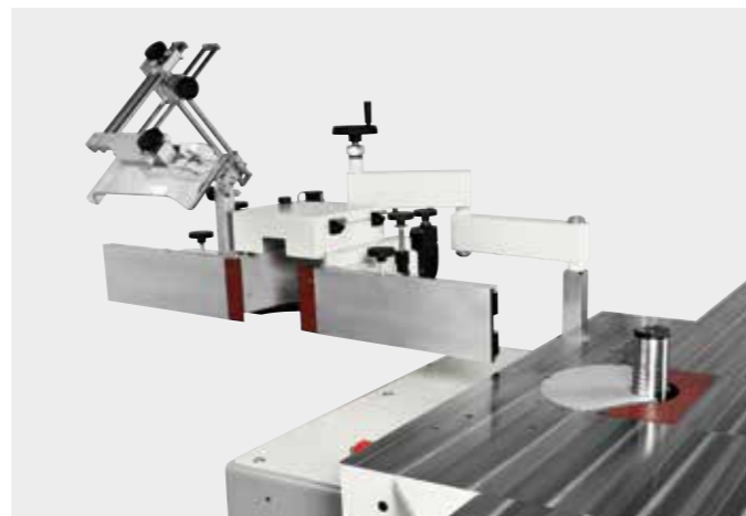
Braccio di esclusione rapida (di serie sulle versioni A). Dispositivo para exclusión de la guía tupí (de serie para las versiones A).
