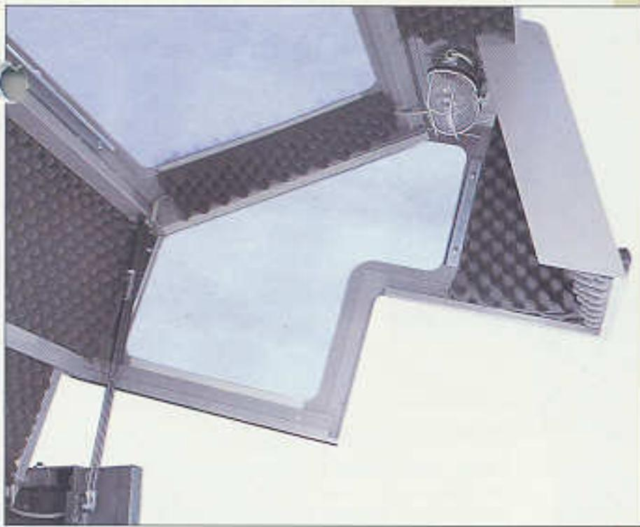
La protezione superiore di sicurezza insonorizzata ed illuminata, montata di serie, garantisce un alto grado di isolamento acustico ed un'ampia visibilità della zona di lavoro.
