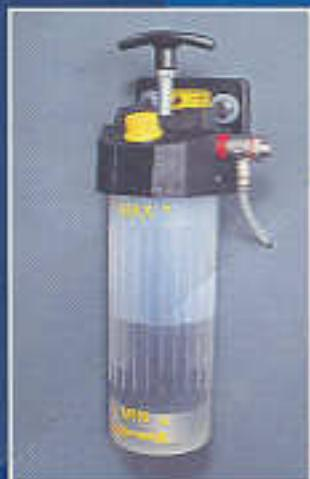
La MATRIX può essere dotata a richiesta, di una pompa di lubrificazione manuale per facilitare lo scorrimento di pezzi bagnati o resinosi.
