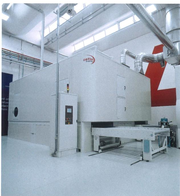
Forno verticale a vassoi a nastro motorizzati, per essiccazione anche di vernici ad acqua. Cefla Finishing ha previsto per questa versione la movimentazione dei vassoi senza l'uso di catene (brevettato).
