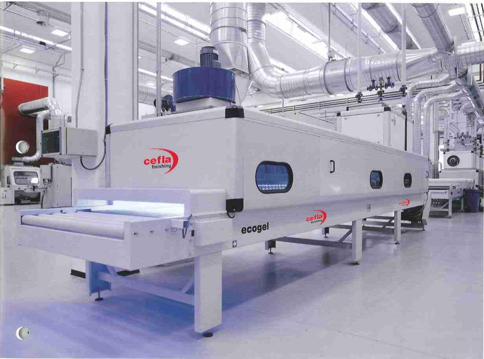
Forno con controllo progressivo di potenza che consente una essiccazione perfetta di vernici PEUV, minimizzando il tempo di essiccazione e l'impiego di potenza (brevettato).
