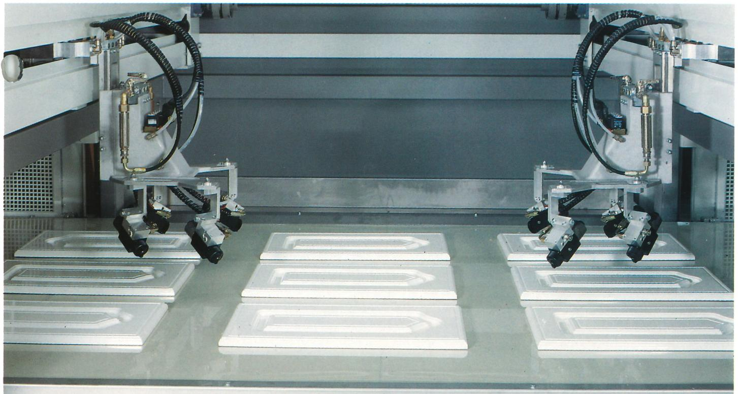
Cabine de protection (en option) pour les cycles de vernissage qui demandent une ambiance hors-poussières dans la zone d'application (par ex.: cycle brillant direct).
