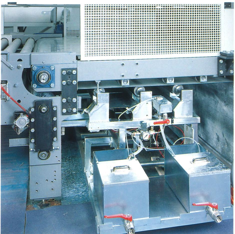
Zone de pistoletage avec l'ensemble des pistolets et le tapis continu de transport des pièces. L'air est alimenté entre les deux groupes de pistolets pour limiter les turbulences.
