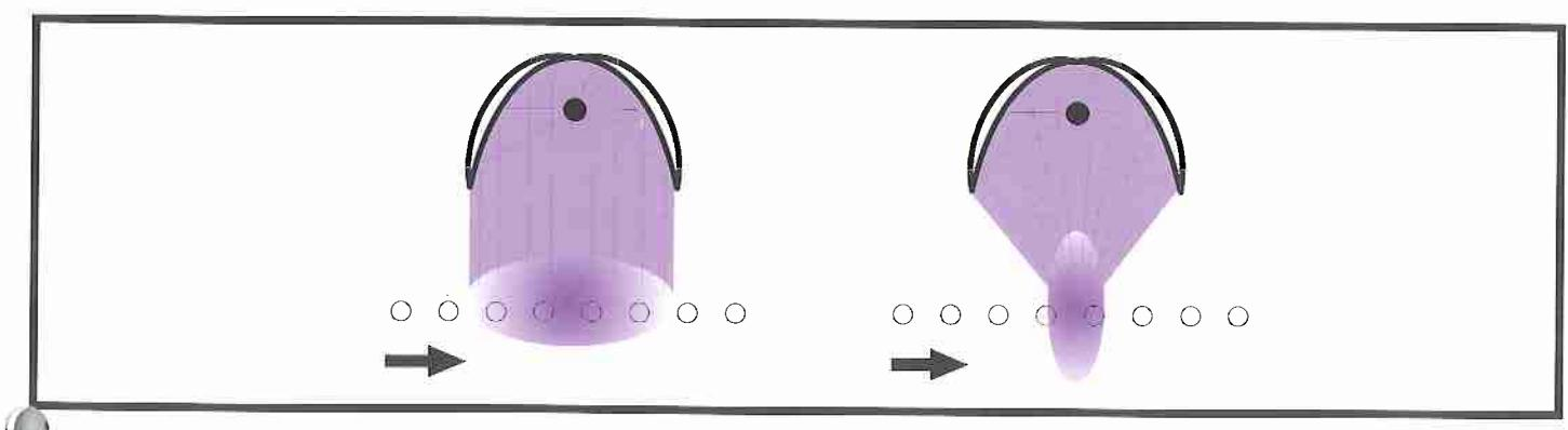
Possibilità di avere parabole a riflessione concentrata o diffusa in funzione del tipo di vernice UV utilizzata (acrilica o poliestere).
