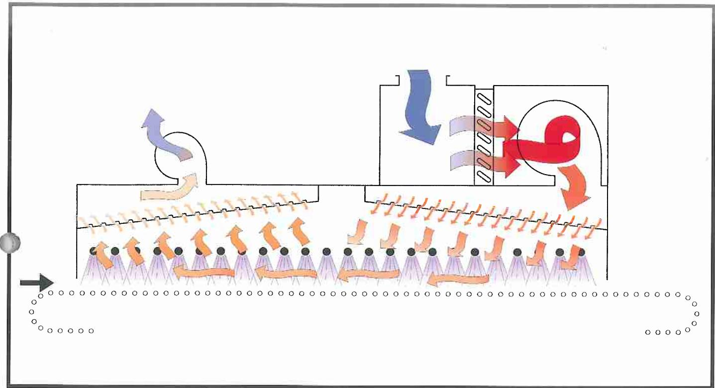
Forno con distribuzione dell'aria laminare a velocità controllata per l'appassimento di finiture di alta qualità.
