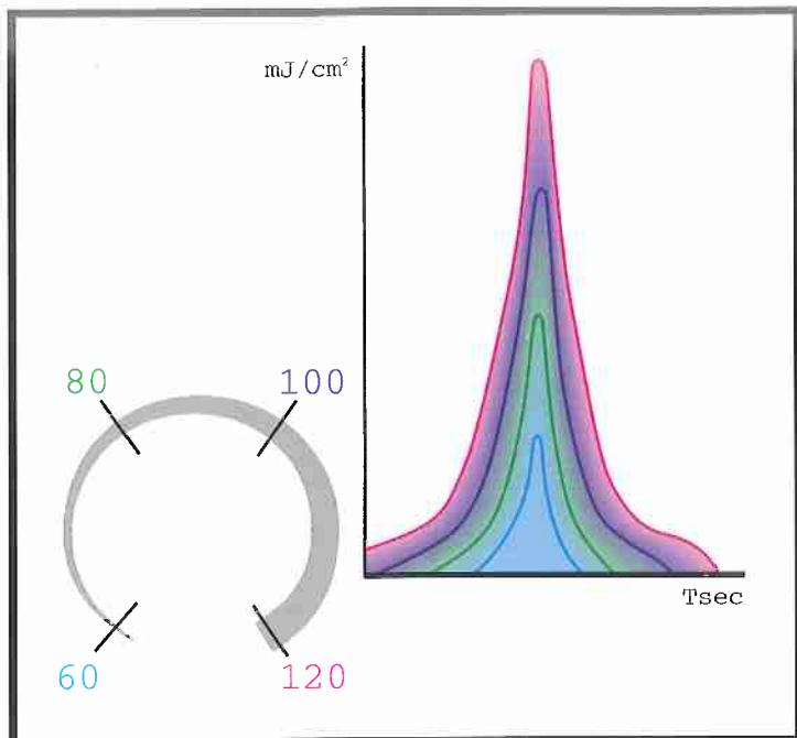
Regolazione continua della potenza specifica delle lampade da 60 a 120 W/cm.
