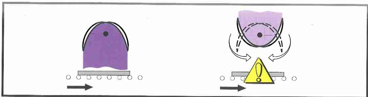
L'innovativo sistema di rotazione della plafoniera con occultamento della luce UV, migliora la sicurezza in caso di arresto della linea.
