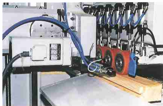
Piallatura con recupero listello fermavetro Planing with collection of glass holding elements
