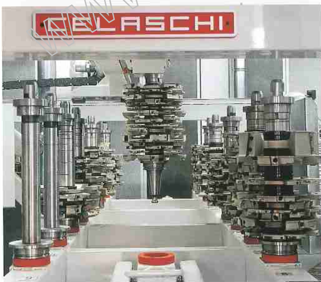
Magazzino portamandrini con disponibilità complessiva di albero da 5 metri fino a 12,5 metri (distribuiti fra tenonatrice e profilatrice). Spindleholder magazine with total availability of 5 mt. up to 12,5 mt shaft (shared between tenoning and profiling machines)
