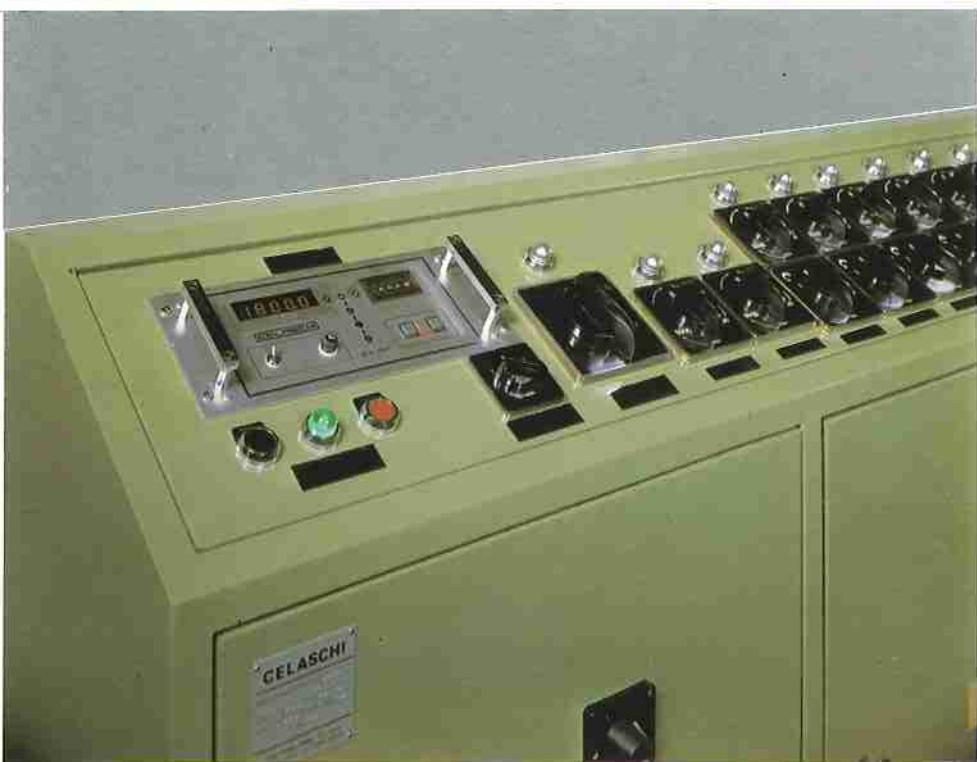
Centralina elettrica di comando con posizionatore elettronico "PS 761,, del montante mobile.
