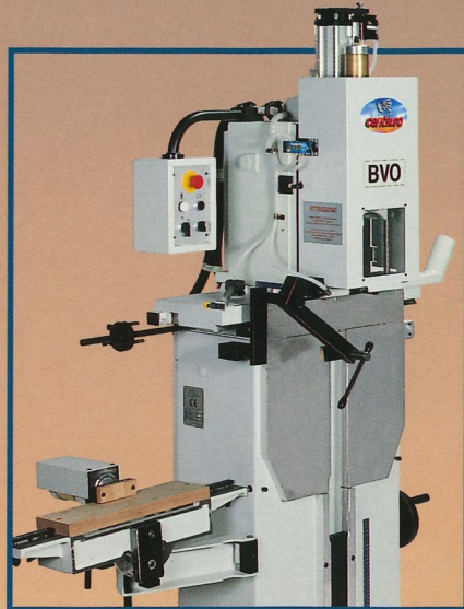
Apertura rapida del piano di lavoro per l'esecuzione della cava nelle porte. Ouverture rapide de la table de travail pour l'exécution de la mortaise dans les portes. Rapid opening of the working table to produce slots in the door. Schnelle Öffnung des Arbeitstisches für die Ausführung von Schlitzten in der Tür.
