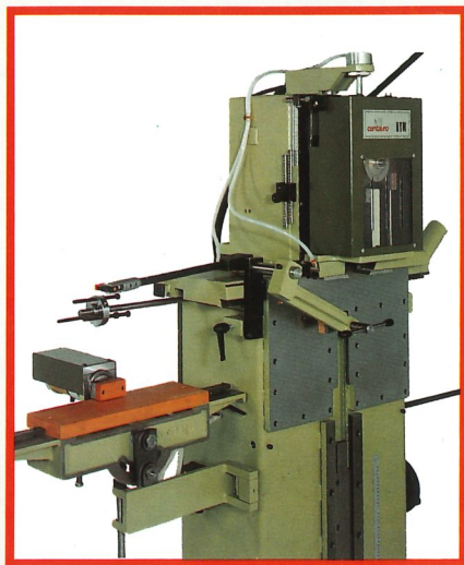
Apertura rapida del piano di lavoro per l'esecuzione della cava nelle porte. Ouverture rapide de la table de travail pour l'exécution de la mortaise dans les portes. Schnelle Öffnung des Arbeitstisches für die Ausführung von Schlitzten in der Tür. Rapid opening of the working table to produce slots in the door.
