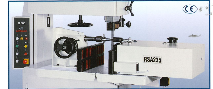
RSA235: autocentrante ad apertura pneumatica / à centrage automatique et ouverture pneumatique pneumatically-operated self-centring feeder / Selbstzentrierapparat, pneumatisch betätigt
