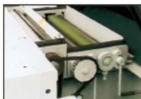
Réglage de pression des rouleaux arrière commandé par l'extérieur.
