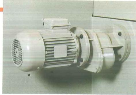
Das Förderband wird von einem über Inverter gesteuerten Getriebemotor angetrieben. Der Bediener kann an der Schalttafel mit Hilfe des zugehörigen Potentiometers die Drehzahl und somit die Vorschubgeschwindigkeit regeln. Die Einstellung wird an der zugehörigen Skala angezeigt.
