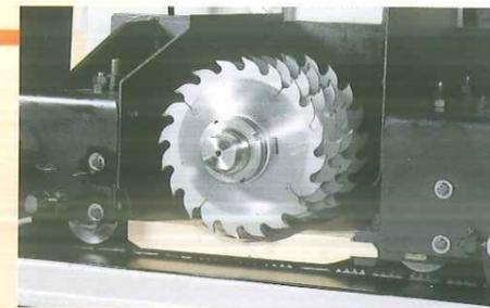
Die Sägeblätter werden direkt auf der Welle montiert (Montagebüchse optional)
