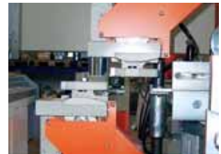
DISPOSITIVO SPIGOLATORI CON COPIATORE AUTOMATIC CHAMFER RING (WITH COPIO)
