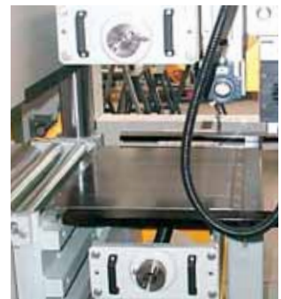
GRUPPO 5° ALBERO INFERIORE O SUPERIORE 5° TOP OR BOTTOM SPINDLE UNIT
