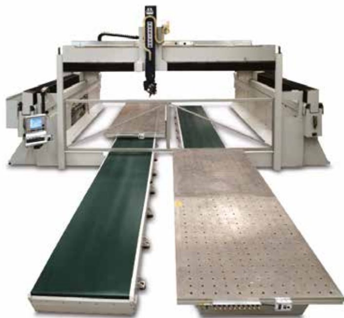
LE TAVOLE ESTRAIBILI APC CONSENTONO CARICO E SCARICO ALL'ESTERNO DELL'AREA DI LAVORO
