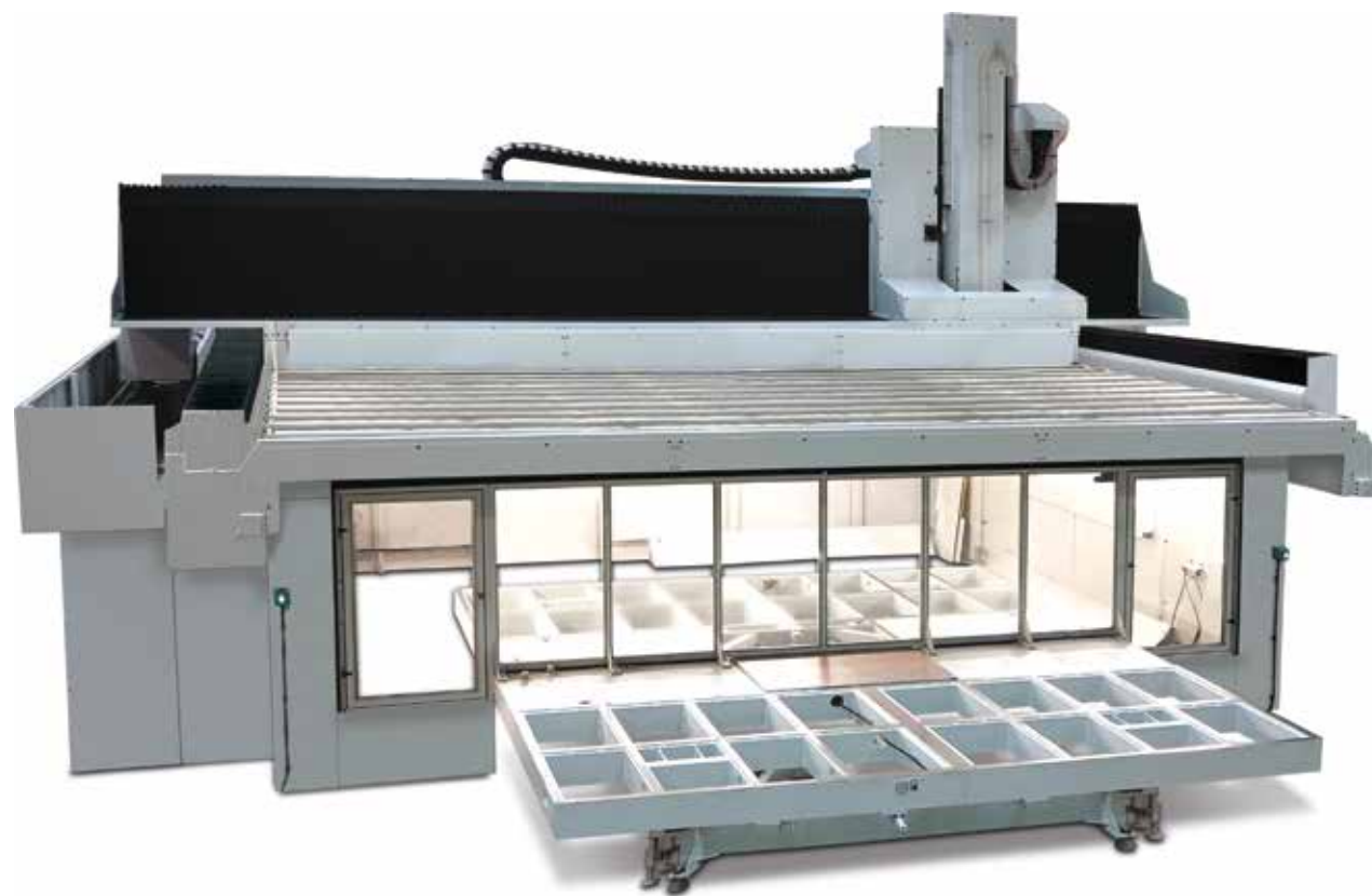
TAVOLA GIREVOLE: SEMPLIFICA IL CARICO/SCARICO FUORI DALLA MACCHINA E PERMETTE IL CICLO PENDOLARE USANDO LA COMPLETA AREA DI LAVORO
