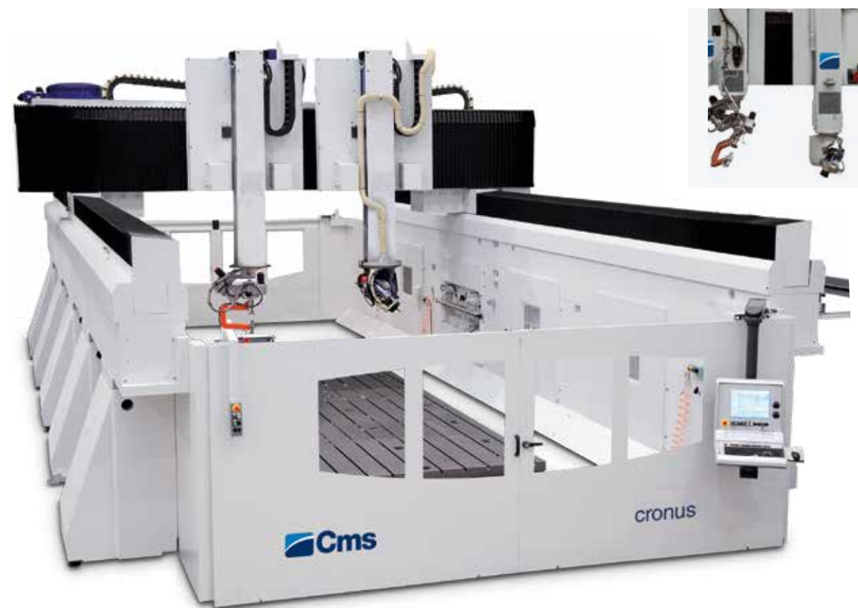
SOLUZIONE IBRIDA 5-ASSI: FRESA + TAGLIO A GETTO D'ACQUA CON CATCHER
