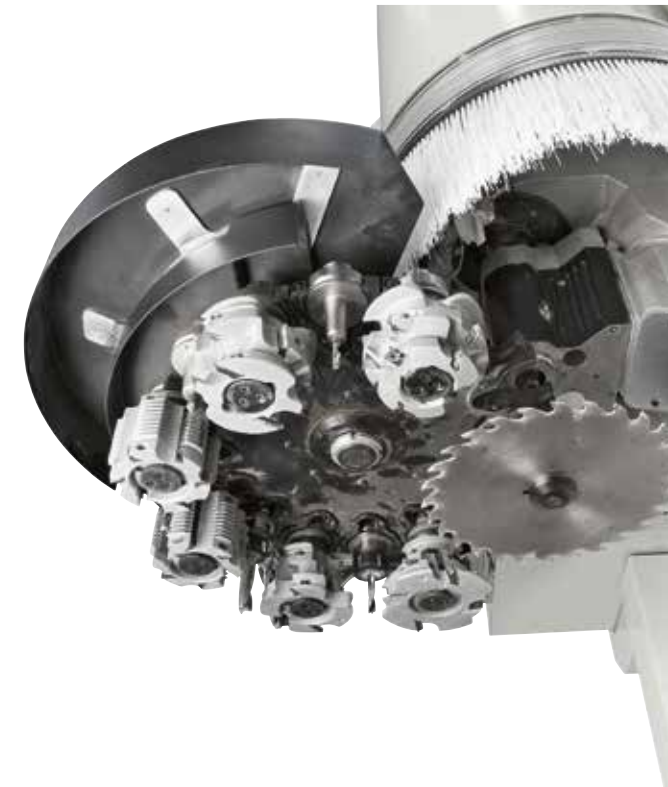
RAPID 24 o 16 posizioni Magazzino circolare ancorato al portale mobile, per avere sempre a disposizione tutti gli utensili.
