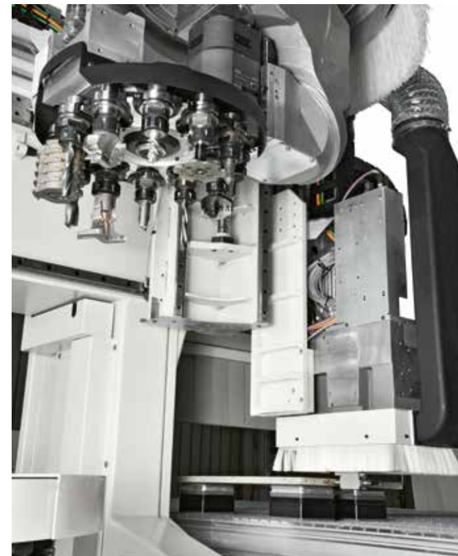
RAPID 12 ON-BOARD 12 posizioni Magazzino circolare posizionato a bordo del gruppo operatore, effettua il cambio utensile del mandrino principale durante le operazioni di foratura.
