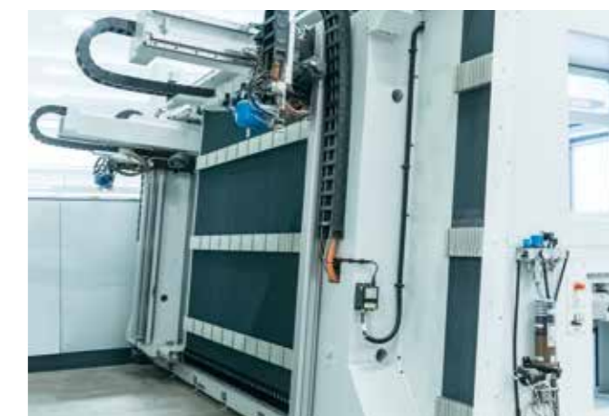
CABINATURA INTEGRALE Cabinatura integrale completa di chiusura posteriore a soffietti
