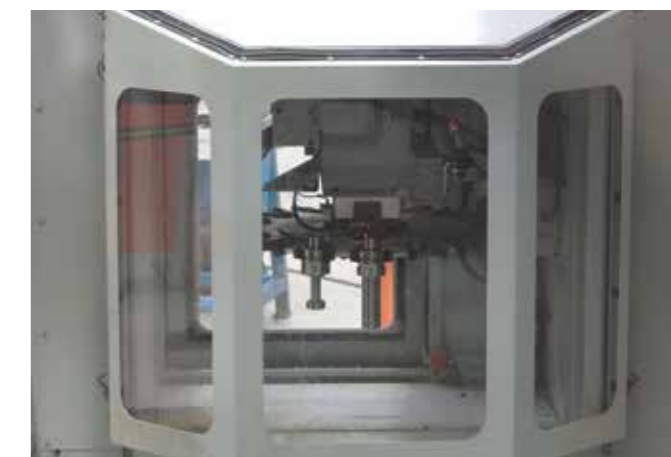
MAGAZZINO UTENSILI Accessibilità in totale sicurezza e protezione dalle polveri
