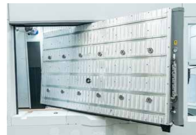
PIANO DI LAVORO Il piano di lavoro può essere customizzato in funzione delle esigenze del cliente (Zero-Point, Vacuum, T-Slots... etc)
