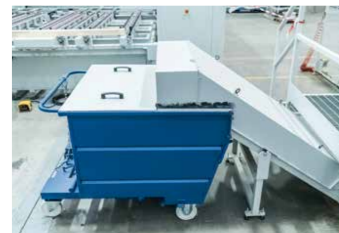
TAPPETO CONVOGLIATORE TRUCIOLI Facile rimozione di polveri, trucioli e sfridi
