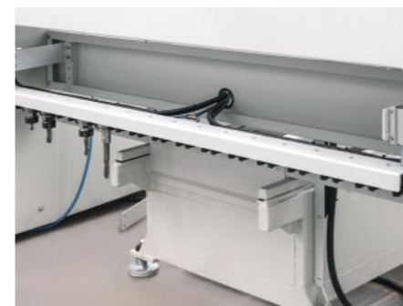
Magazzino cambio utensili a 16 stazioni
