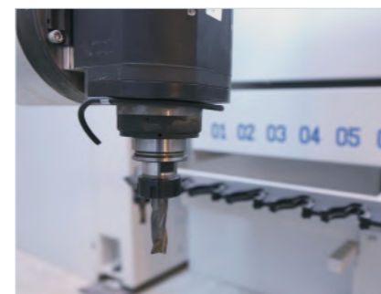
Magazzini cambio utensili fino a 64 stazioni
