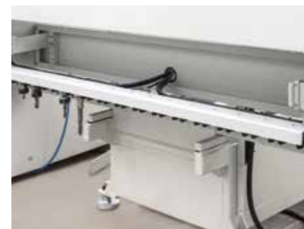
Magazzino cambio utensili a 16 stazioni
