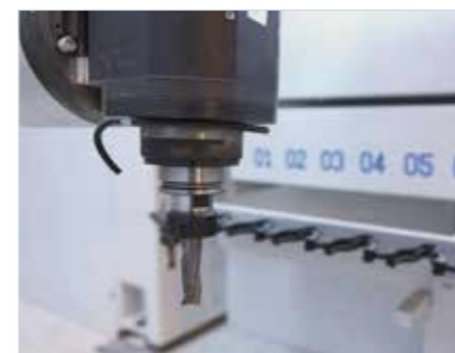
Magazzini cambio utensili fino a 64 stazioni
