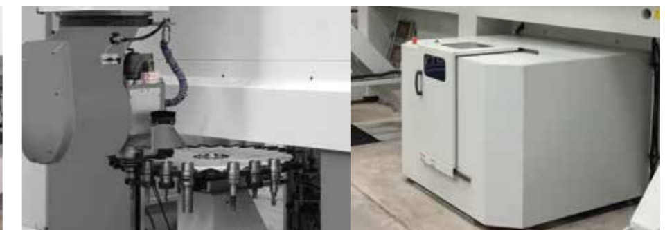
Vista interna ed esterna magazzino cambio utensili a 30 stazioni
