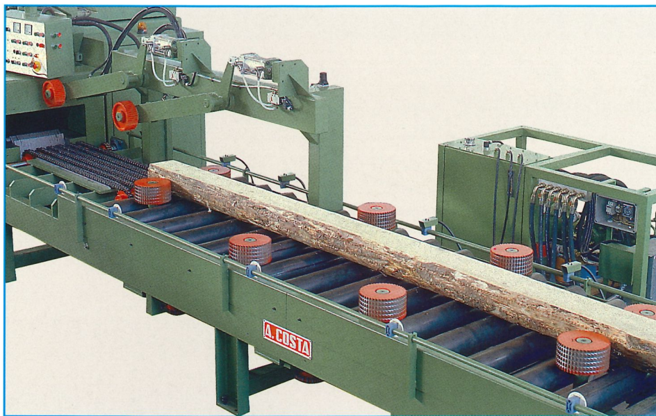
5- Centratore prismi Cants centering unit Centrador de prismas en carrera Modelzentriervorrichtung Центрирующее устройство для брусков
