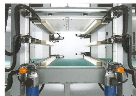
Zone de pressage d'une machine configurée avec trois couples de pressoirs et groupe agrafeurs.
