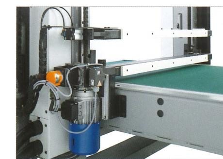
Groupe de déplacement vertical des pressoirs développé pour garantir la liberté maximale de positionnement.
