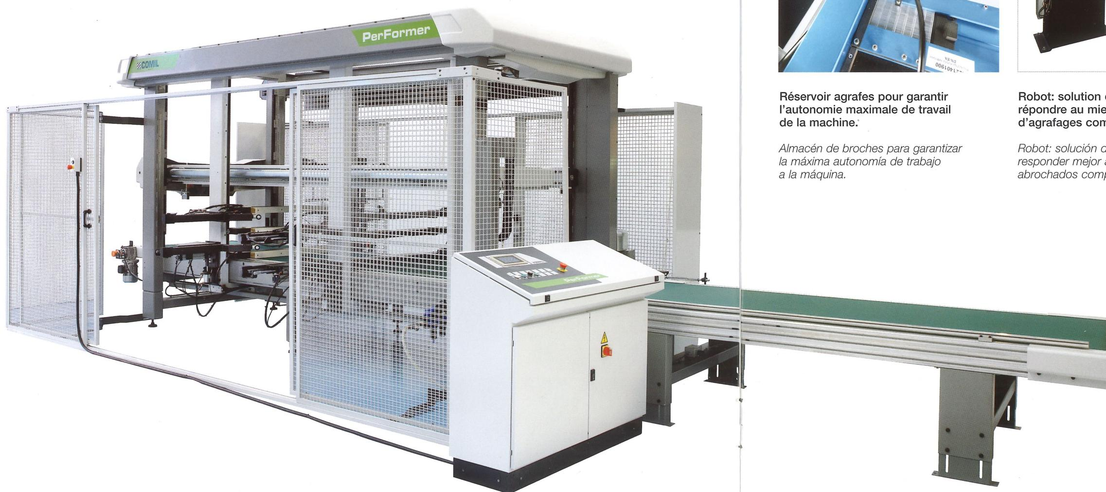
La volucadreuse Performer XP configurée en version autocentrale est particulièrement indiquée pour répondre aux exigences de prestations élevées et en présence de meubles pour lesquels une machine à double montant est nécessaire.
