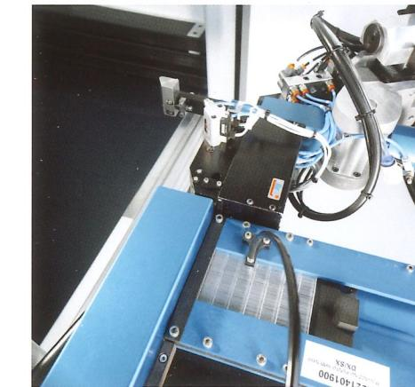
Réservoir agrafes pour garantir l'autonomie maximale de travail de la machine.
