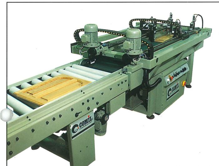
Cadreuse automatique, électromécanique pour portes mod. SEM avec transport spécial à rouleaux motorisés.
