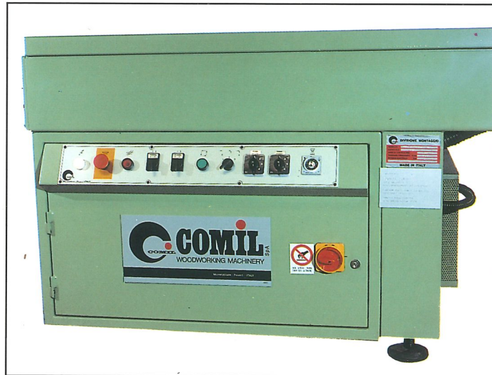
Panneau de distribution électrique.
