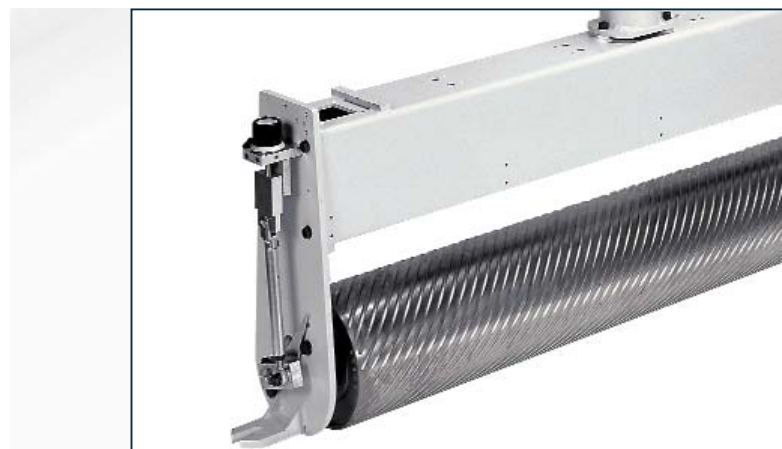
Rulli calibratori in acciaio a sostituzione di quelli gommati.
