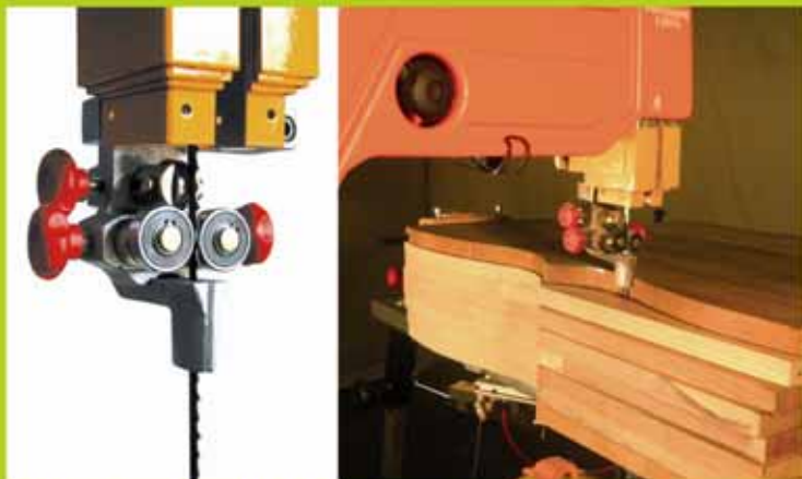
Im Foto oben Kopierwerkzeug mit Formkopie als Beispiel.
