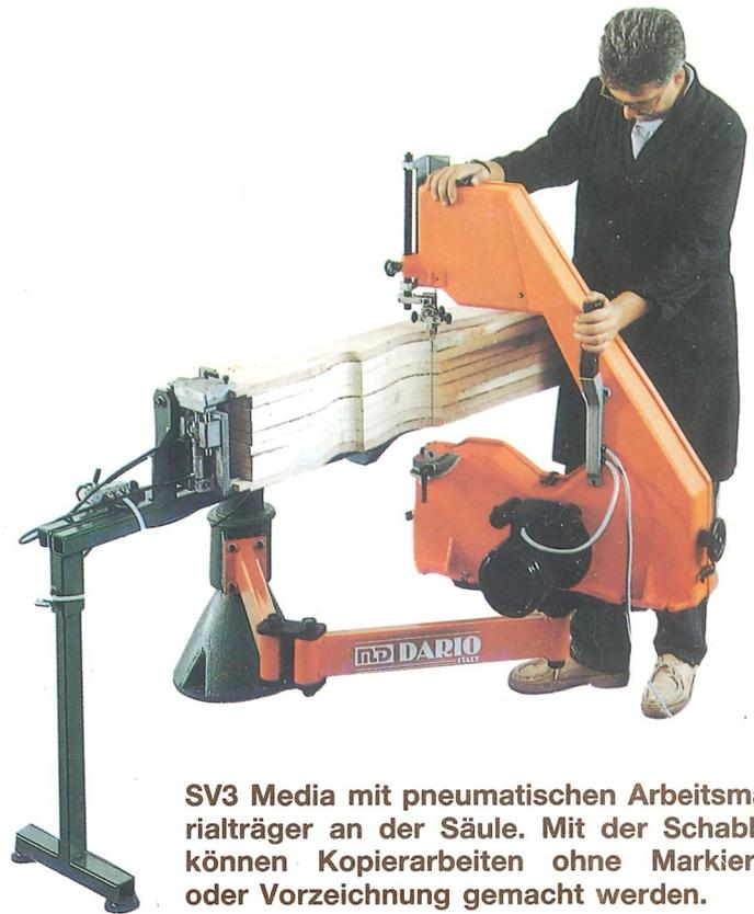
**SV3 Media mit pneumatischen Arbeitsmaterialträger an der Säule. Mit der Schablone können Kopierarbeiten ohne Markierung oder Vorzeichnung gemacht werden.**
