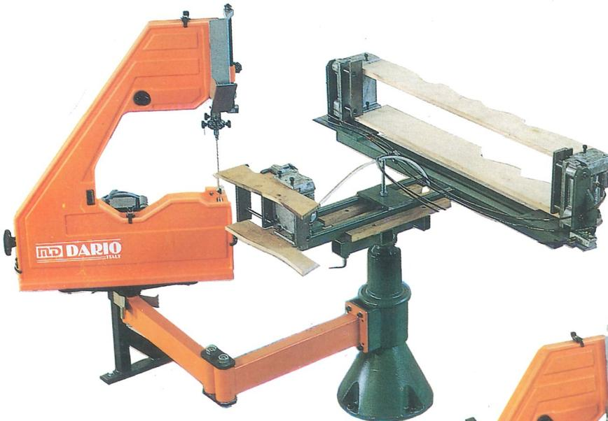
**SV3 Media mit Säule kann durch hinzufügen einer oder mehrerer Arbeitsstationen für Arbeiten an Holz auch in grösseren Lagen verwendet werden.**
