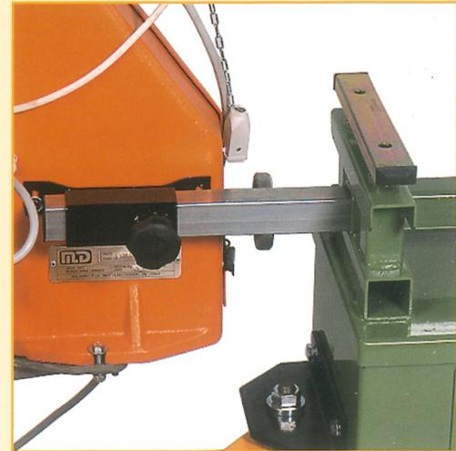
Dank einer speziellen **BLOCKIERVORRICHTUNG** kann die Bandsäge SV3 MEDIA mit dem mitgelieferten Arbeitstisch wie eine traditionelle Standbandsäge benutzt werden.
