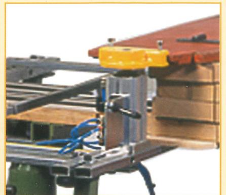
Detail des pneumatischen Zylinders der Materialhalterung
