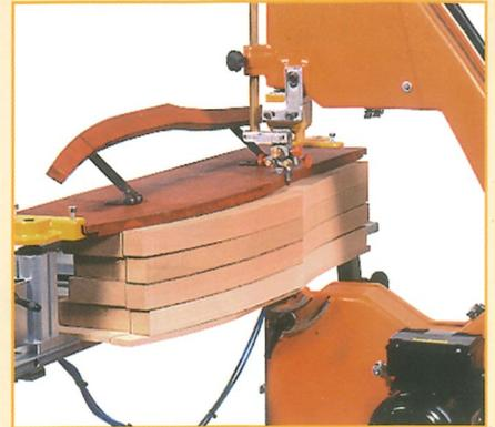
Beispiel eines Schnittes mittels Schablone und Kopiervorrichtung
