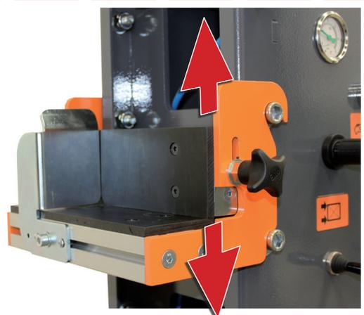
**Kit DOOR** incorpora un sistema aplacadores frontales en las cuatro esquinas de prensado.
