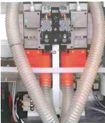
Gruppo rettificatore in entrata. Due motori ad alta frequenza dotati di intervento a tempo automatico per evitare scheggiature sul pannello. Il gruppo è completo di una coppia di fresaie.
