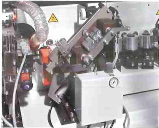
Gruppo intestatore con motore ad alta frequenza per il taglio a 90° del bordo eccedente nella parte anteriore e posteriore del pannello.
