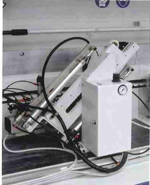
Gruppo intestatore con 2 motori indipendenti ad alta frequenza per il taglio del bordo eccedente nella parte anteriore e posteriore del pannello. Elevata precisione di lavorazione ed affidabilità in quanto i motori scorrono su guida prismatica con pattini a ricircolo di sfere con conseguente totale assenza di giochi.
