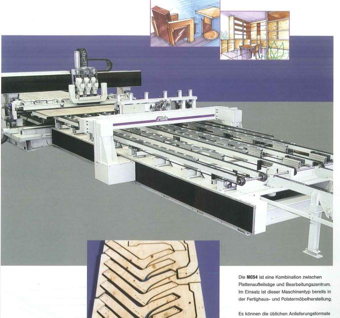
Es können die üblichen Anlieferungsformate der Rohplatten eingesetzt werden: Zeitaufwendige Rüstzeiten mit Saugern oder Spannvorrichtungen entfallen. Die Rohplatten können einzeln oder im Stapel bearbeitet werden. Die Bearbeitung von Freiformflächen, Ausklinkungen und Aufteilung erfolgt in einer Aufspannung. Die optimierte Werkstückverschachtelung auf den Rohplatten reduziert den Rohmaterialeinsatz wesentlich.
