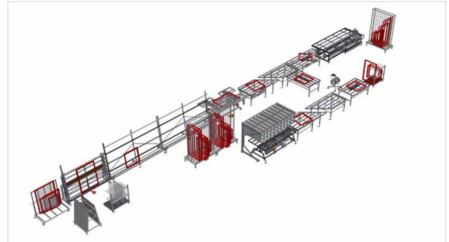
Beispiel einer Montagelinie für Fenster- und Türenfertigung mit PVC
