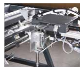
8-fach Höhenverstellung (Option) 8-fach Höhenverstellung für unterschiedliche Schraubhöhen FAZ 2800 Art. Nr. 256 20 02 06 27
