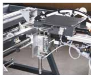
Schraubeinheit Schraubeinheit fahrbar mit pneumatischer Höhenverstellung. Handeinwurftrichter für zweite Schraubenlänge. Automatische Tiefenabschaltung
