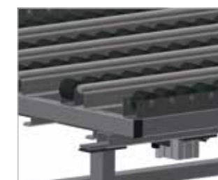
Rollenauflage kpl. für HT 3000/Alu Kunststoffröllchen mit Polyurethanbeschichtung, kugellagert, Tragkraft pro Rolle: 40 kg, transport- und handhabungsfreundlich für Alu-Elemente HT 3000 Art. Nr. 250 20 05 36
