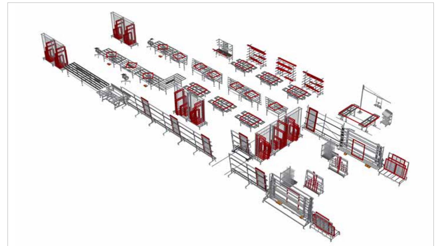
Beispiel einer Montagelinie für Fenster- und Türenfertigung mit Aluminium
