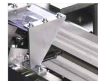
Lasereinheit (Option) Laser für Schraubposition FAZ 2800 Art. Nr. 255 20 63 19
