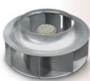
Pour améliorer les performances du compresseur, sur la série AIRBLOK SD a été adopté un système de ventilation silencieux et efficace. Un ventilateur radial à hauteur d'élévation importante atteint un rendement élevé à faible vitesse de rotation en garantissant une économie d'énergie sensible et un faible niveau de bruit. La facilité d'accès au système de ventilation permet une intervention rapide en cas d'anomalie.
