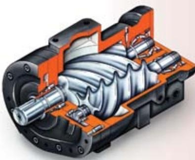
Le groupe vis est caractérisé par une haute efficience à basse vitesse de rotation grâce au dimensionnement adapté des rotors, à l'étude des profils et au choix optimal du nombre de lobes avec pour conséquence la réduction du niveau de bruit. La fiabilité du groupe est assurée par le surdimensionnement des roulements portants et de poussée, par un joint pare-huile à double lèvre avec étanchéité parfaite sur l'arbre du rotor meneur et par le refroidissement à injection d'huile.
